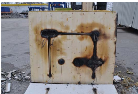
Abbildung 41: Brandbeanspruchung im Bereich der Elektrodosen hinter der Kapselbekleidung in Massivholzbauteilen [19]
