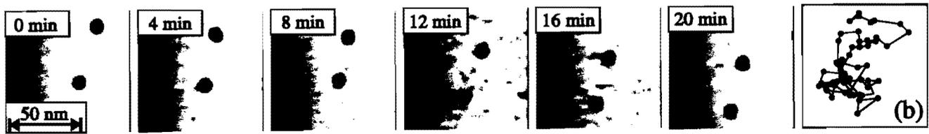
**Abbildung 3.3:** Leerstelleninselbewegung: Relative Bewegung zweier Leerstelleninseln gleicher Größe;  $U_t = -0,49$  V,  $I_t = 9,5$  nA, RT; (b) relative Verschiebung für alle 56 Bilder des Films, vergrößert um einen Faktor 3,  $\Delta t = 30$  s.
