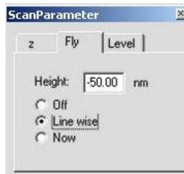
Abbildung 4: Eingeben der Flughöhe im Parameterfenster
