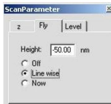
Abbildung 4: Eingeben der Flughöhe im Parameterfenster
