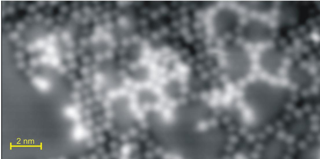
**Abbildung 26:** *STM-Bild mit Molekülen unterschiedlicher Helligkeit. 160 pA, 219 mV*
