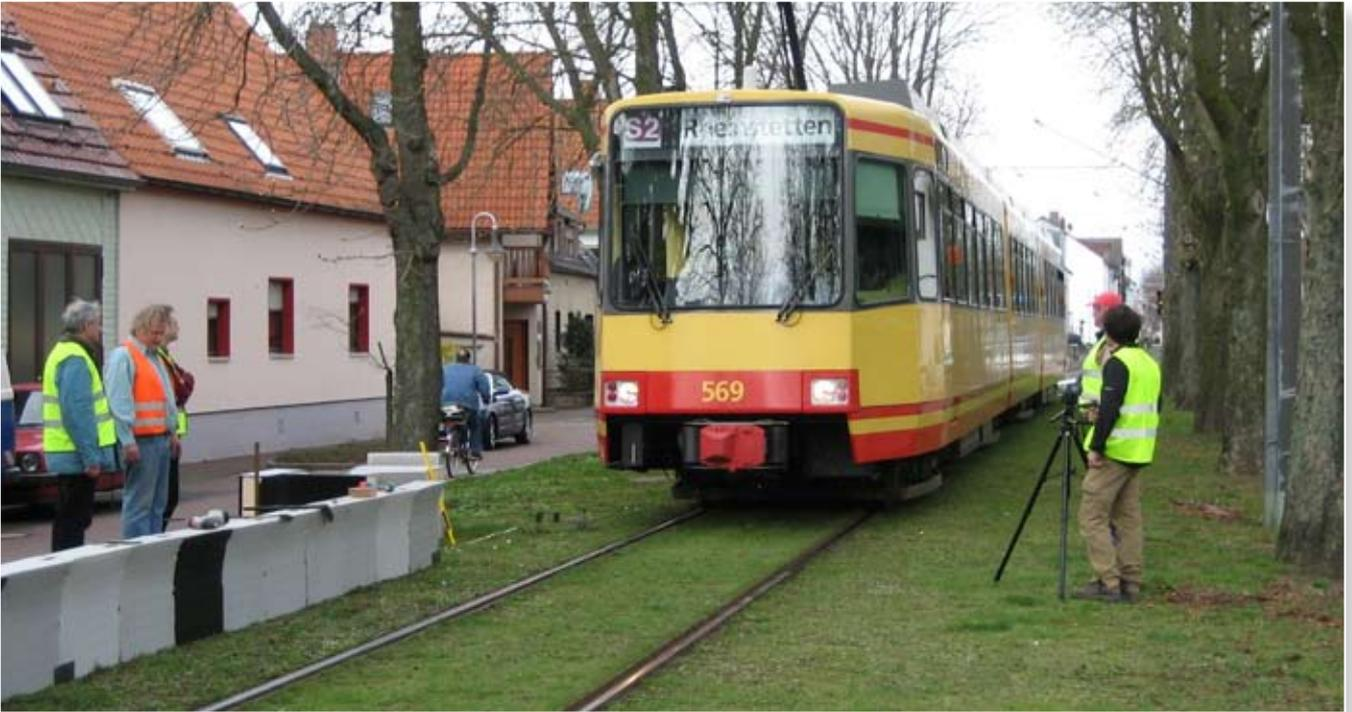
*Aufbau eines Mini-Schallschutzwandprototyps an einer Rasengleis-Teststrecke der Verkehrsbetriebe Karlsruhe*
