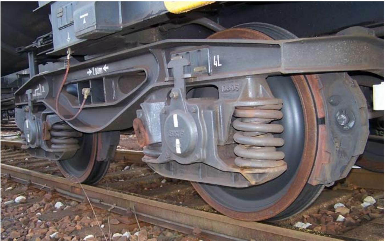
Heute üblicherweise verwendetes Standardgüterwagendrehgestell Y 25 mit Reibungsdämpfung unter einem Containertragwagen
