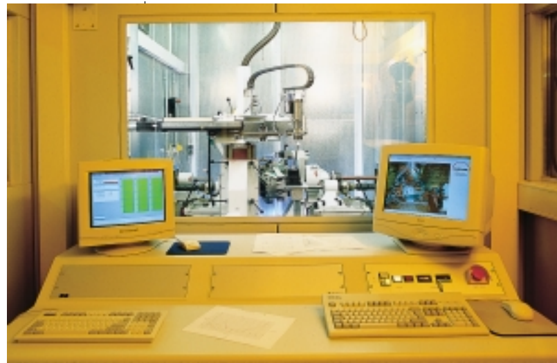
Abb. 4: Prüfstands-simulation zum Pascal-Test: Hier durchläuft ein Getriebe in kurzer Zeit sein ganzes Leben - im Blickfeld des Ingenieurs und unter ständiger Kontrolle moderner Computertechnik.
