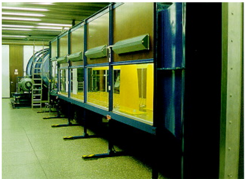
Bild 3: Der Bochumer Grenzschichtwindkanal nach 'Eiffelscher' Bauart. Der Luftstrom (Windgeschwindigkeiten zwischen 0,5 und 30 m/s) wird am Ende der geschlossenen Messstrecke durch ein Axialgebläse (Bild links, Hintergrund) aus der Umgebung des Windkanallabors angesaugt
