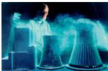
Bild 4: Turbulente Strömung: Laserlicht macht Wind sichtbar.
