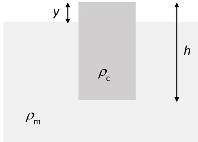
a) die Kontinente müssen eine geringere Dichte haben:  $\rho_c < \rho_m$ . b) Auftrieb = Gewichtskraft der verdrängten Flüssigkeit  $F_A = \rho_m g V = \rho_m g A_c (h - y)$ , wenn man die Querschnittsfläche des Blocks mit  $A_c$  bezeichnet. c) die nach unten gerichtete Gewichtskraft des Blocks wirkt der nach oben gerichteten Auftriebskraft entgegen; die beiden Kräfte müssen sich ausgleichen, da Gleichgewicht herrscht:
