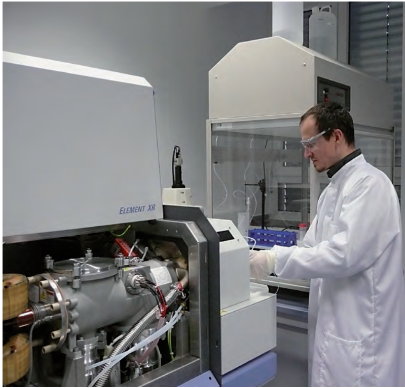
Abb. 122: Arbeiten am Massenspektrometer (Deutsches Bergbau-Museum, Bochum) zur Bestimmung der Bleiisotopen- und chemischen Zusammensetzung. Abb.: Deutsches Bergbau-Museum Bochum.
