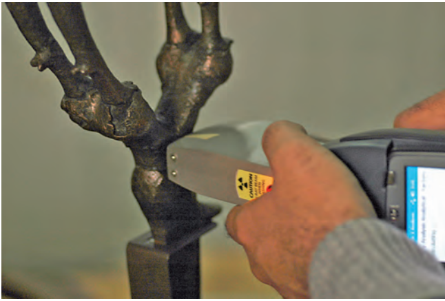
Abb. 120: Im Museum für Anatolische Zivilisationen in Ankara ausgestellten Funde konnten vor Ort und zerstörungsfrei mit einem tragbaren XRF-Gerät analysiert werden.
