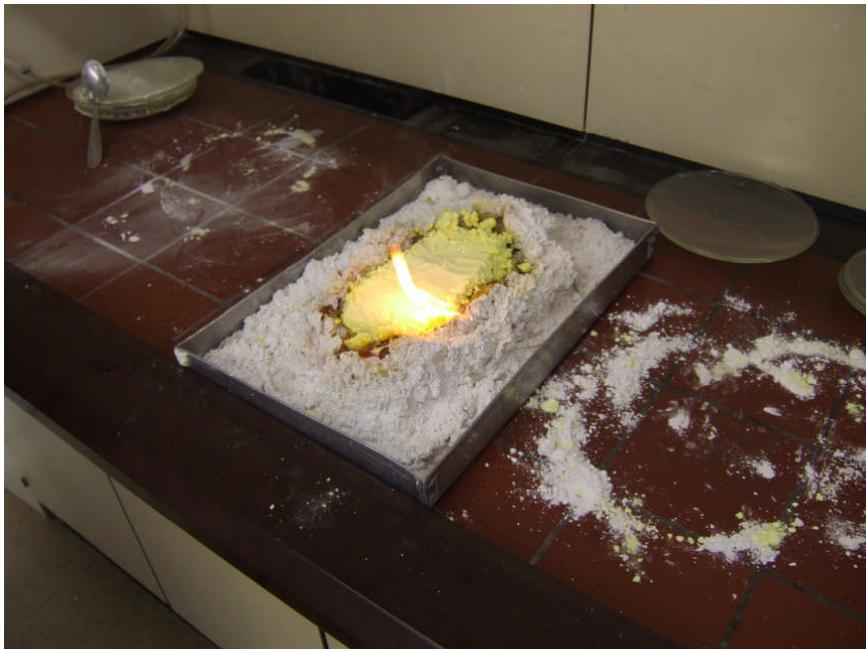
Abb. 6 Das Ergebnis des erfolgreichen Großversuches: Der in der mittelalterlichen Literatur überlieferte chemische Anzünder auf CaO-Basis hat primär Schwefel, sekundär Petroleum entzündet, hat somit erfolgreich gearbeitet — allerdings erst nach einer tiefgreifenden Modifikation des ursprünglichen Rezeptes und nur mit einer Wirkrate von unter 50%.
