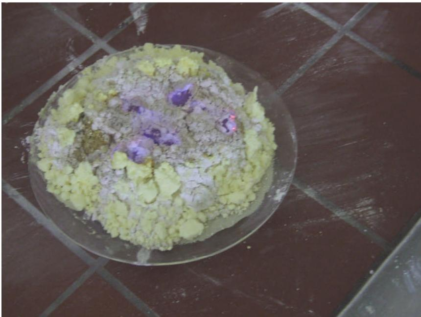
Abb. 2 Schwefel, der auf den Kalk geschüttet war und erst wegen der Volumenvergrößerung des reagierenden Kalkes seitlich abgerutscht ist, hat sich entzündet. Die Temperatur im aktiven Kern ist deutlich über 300° C.. Der Durchmesser der Glasschale ist 20 cm, ca. 150 g Kalk und ca. 100 g Schwefel wurden verwendet.
