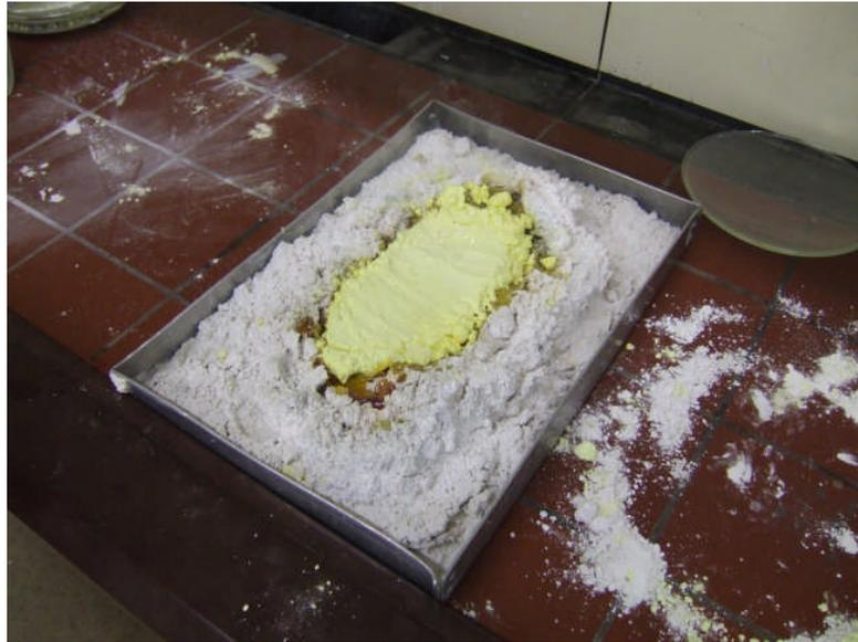
Abb. 5 Der „Großversuch“ mit  $\approx 2,5$  kg Kalk,  $\approx 1$  kg Schwefel,  $\approx 40$  ml Petroleum knapp 2 Minuten nach Beginn der Reaktion. Die dunkelbraune Schwefelschmelze deutet auf eine Oberflächentemperatur von etwa  $200 \dots 250^\circ \text{C}$ , also noch unter der Entzündungstemperatur von  $260^\circ \text{C}$ . Unmittelbar nach dieser Aufnahme, gut zwei Minuten nach Reaktionsbeginn, begann der Schwefel zu brennen
