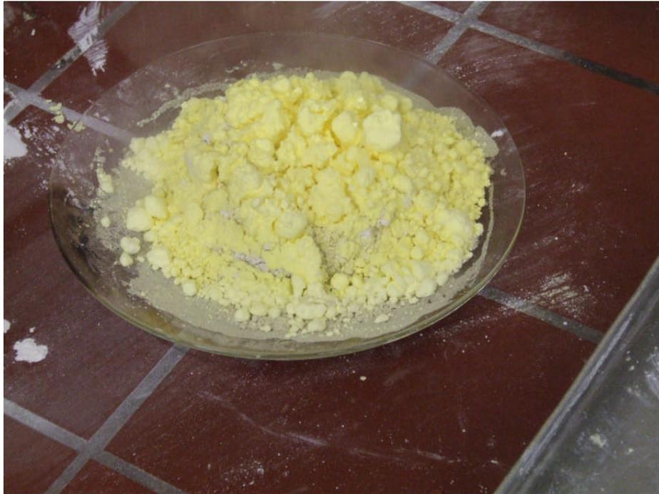
Abb.3 Eine Mischung aus Kalk, Schwefel und Petroleum reagiert auf die Wasserzugabe weniger heftig und langsamer als eine reine Kalk-Schwefel-Mischung. Dementsprechend kommt es nicht zur Entzündung des Schwefels und erst recht nicht zur Entzündung des Petroleums.
