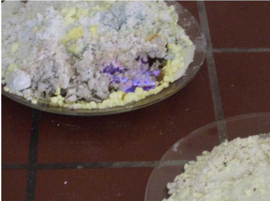
Abb. 1 Der Schwefel hat sich entzündet – aber er brennt nur mit einer kleinen blauen Flamme, Flammhöhe etwa 5 mm, in einer langsam fortschreitenden Front. Die hier abgebildete Situation, etwa 5 Minuten nach Beginn der Reaktion, kann sich so bis zu einer Stunde hinziehen!
