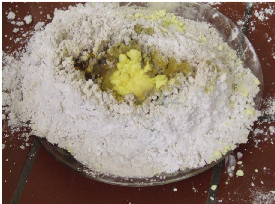
Abb. 4 Schwefel-Petroleum-Mischung im Kalk-Nest, einer der verschiedenen Versuche, mit denen ein wirksames Sekundärfeuer erzeugt werden sollte. Der Schwefel hat sich zum größten Teil gelöst, die dünnflüssige Lösung ist im Kalk versickert.
