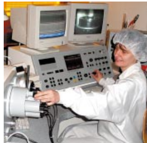
Abb. 4: Bei der Arbeit im sog. Reinraum: Das wichtigste Arbeitsgerät ist das Rasterelektronenmikroskop (REM) - eigentlich zum Abbilden kleiner Strukturen gedacht, „zeichnet“ es hier die Nanostrukturen vor.
