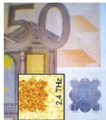
Abbildung 6: Geldschein Hologramm und Papier als Bild bei 2,4 THz aufgenommen mit dem THz Germanium Laser (EB, RUB).
