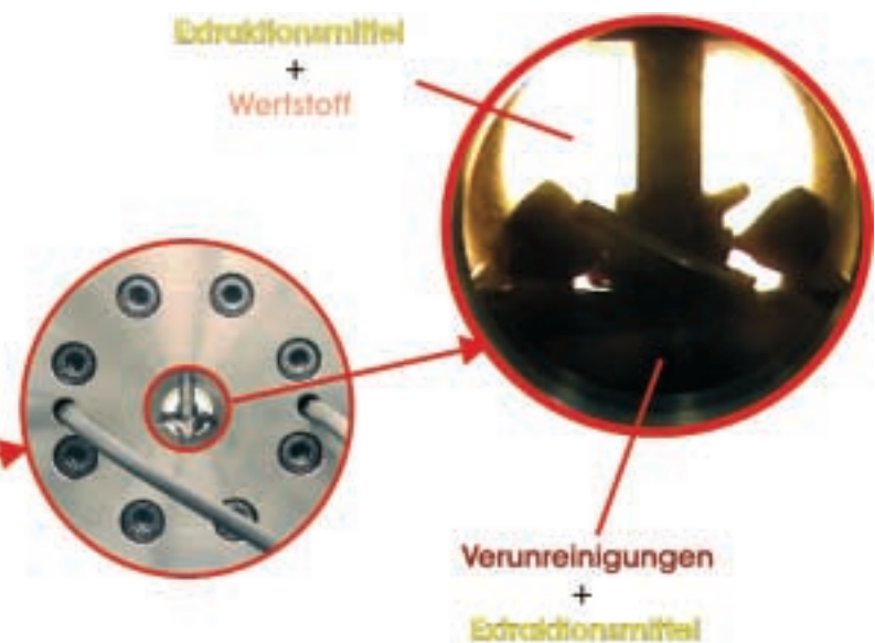
Abb. 6: Hochdrucksichtzelle zur Beobachtung der Löslichkeit des Gases im Altöl und der Altölkomponten im Gas. In der Aufnahme der Zelle erkennt man mittig den Rührer, der eine gute Vermischung verschiedener Stoffe in der Sichtzelle gewährleisten soll. Die Elektrokabel im mittleren Bild speisen Heizpatronen, die die Sichtzelle temperieren.
