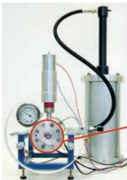
Abb. 6: Hochdrucksichtzelle zur Beobachtung der Löslichkeit des Gases im Altöl und der Altölkomponten im Gas. In der Aufnahme der Zelle erkennt man mittig den Rührer, der eine gute Vermischung verschiedener Stoffe in der Sichtzelle gewährleisten soll. Die Elektrokabel im mittleren Bild speisen Heizpatronen, die die Sichtzelle temperieren.
