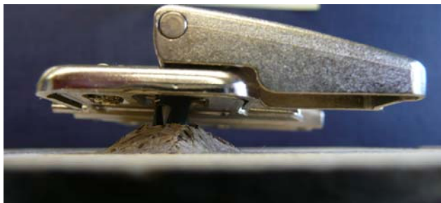
Spreizdübel nach einem Auszugsversuch
