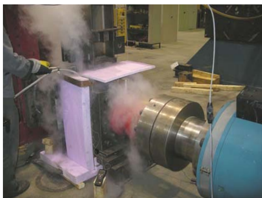
Bild 2: Versuchsdurchführung unter Einsatz von Flüssigstickstoff
