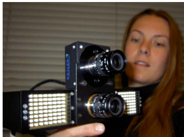
Bild 1: ToF-Kamera und 2D Kamera
