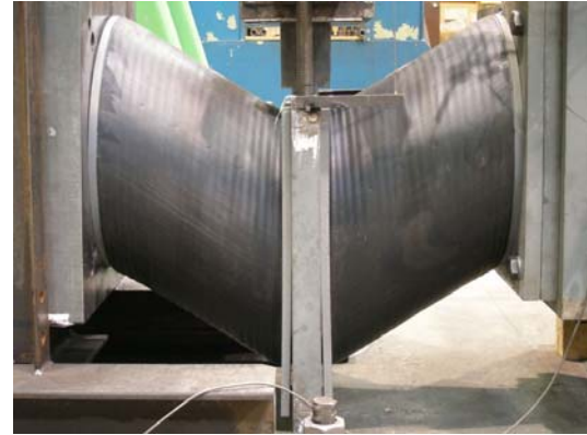
Bild 1: Bewehrte Elastomerlager unter Druck- und Schubbeanspruchung
