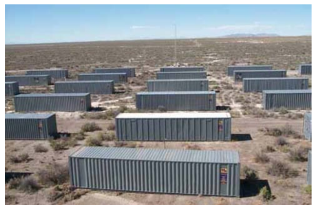
Bild 1: MUST- Experiment, 12x10 Schiffscontainer (12,2 m lang, 2,42 m breit, 2,54 m hoch)
