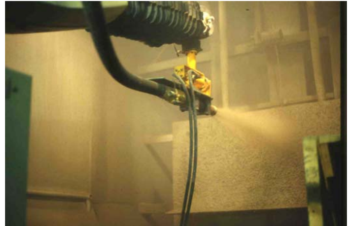
Bild 2: Spritzbetonversuchsstand im Einsatz
